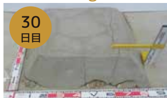
安定処理土 (w=100% セメント 55kg/m 3 )
