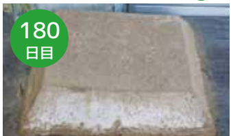
ボンテラン改良土 (w=100% セメント 55kg/m 3 ボンファイバー 25kg/m 3 )
