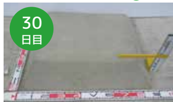
安定処理土 (w=100% セメント 55kg/m 3 )
