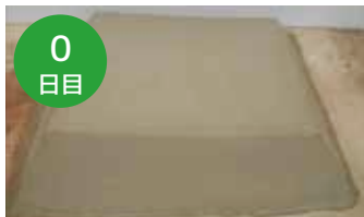
安定処理土 (w=100% セメント 55kg/m 3 )
